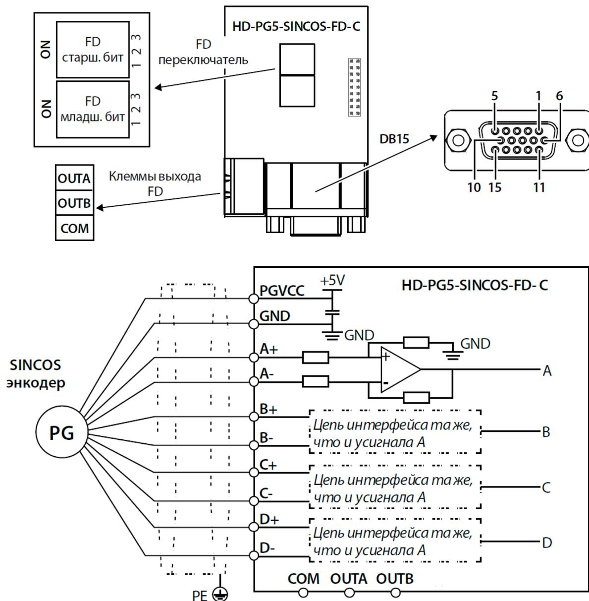
Рисунок 5.7 – Плата подключения энкодера HD-PG5-SINCOS-FD-C
