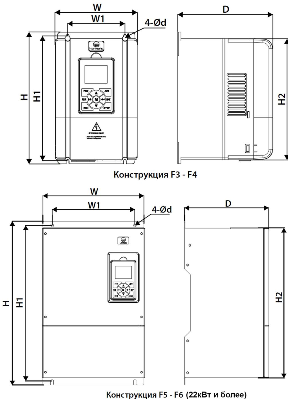
Рисунок 3.2 Габаритные размеры
