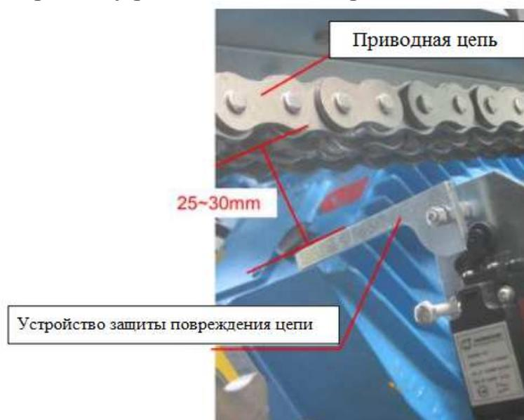
Рисунок 1.61 – Устройство защиты повреждения цепи.
