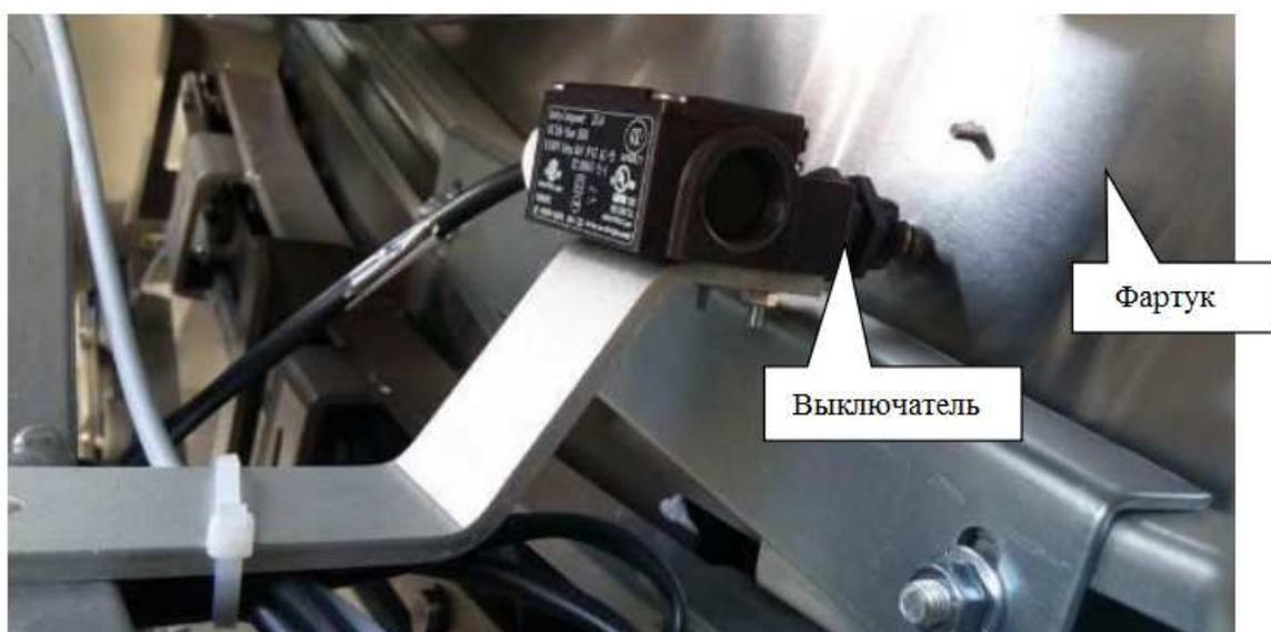
Рисунок 1.77 – Выключатель безопасности фартука (фото).
