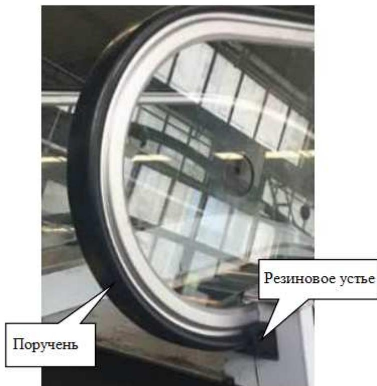
Рисунок 1.68 – Устройство контроля поручня (исполнение 1).
