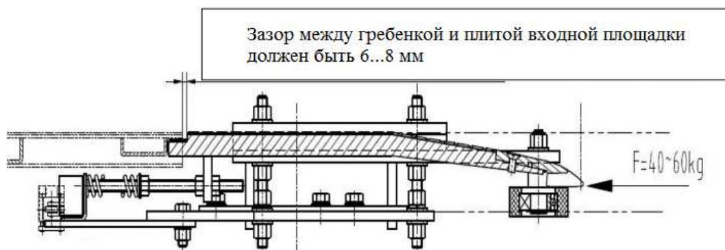
Рисунок 1.75 – Устройство безопасности гребенки.
