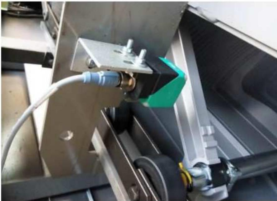
Рисунок 1.66 – Боковой датчик отсутствия ступени/паллеты (фото для справки).
