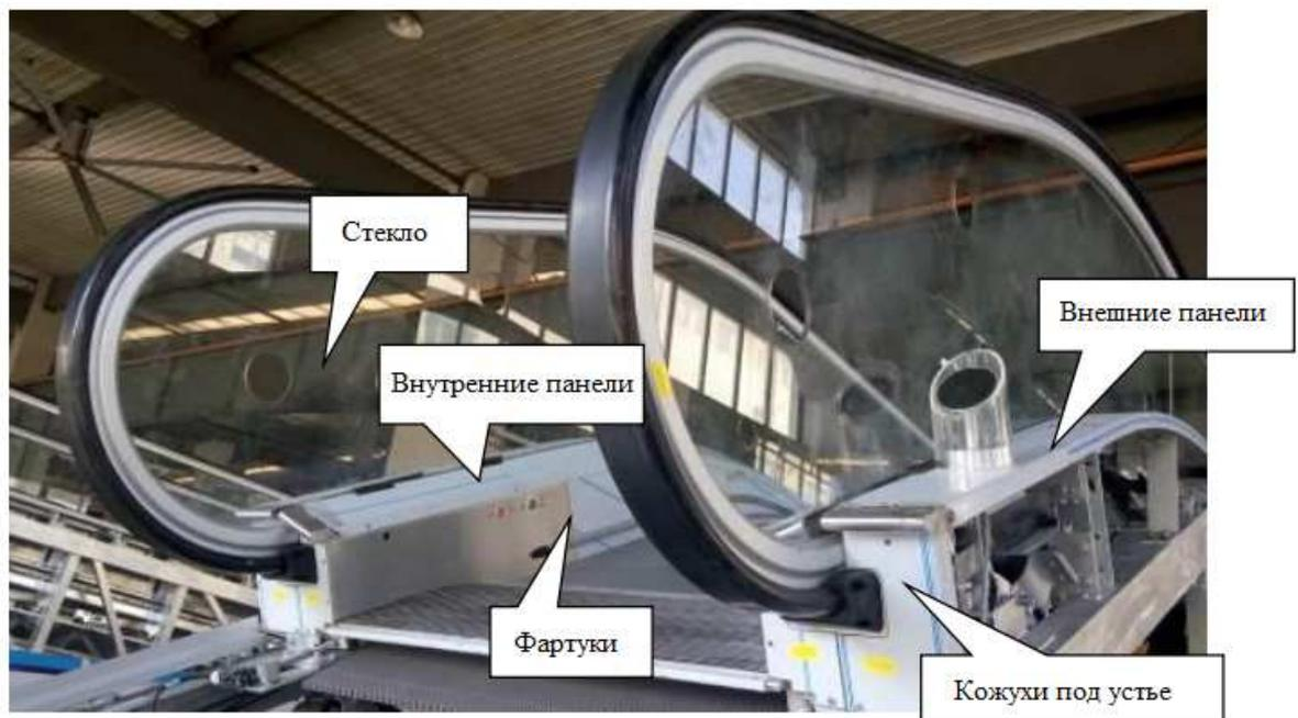
Рисунок 1.54 – Структура ограждения эскалатора.
