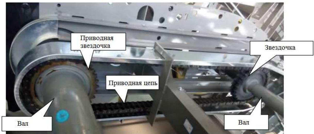
Рисунок 1.44 – Привод поручня.
