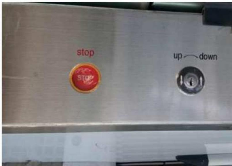
Рисунок 1.80 – Кнопки аварийного выключения.
