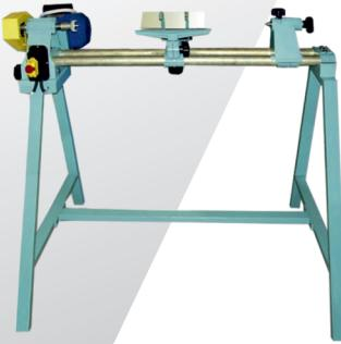
Станок предназначен для выполнения продольной и торцевой токарной обработки заготовок из древесины.
