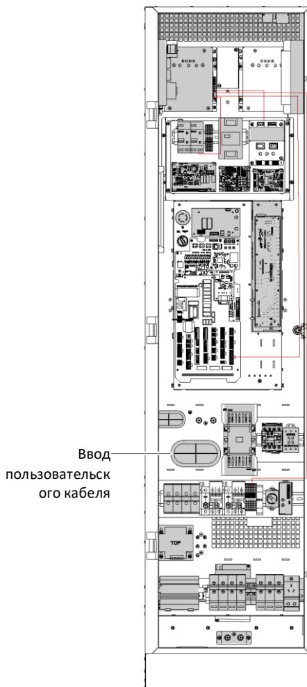
Рисунок 1-29 Подключение электрического размыкателя тормозов шкафа управления MRL
