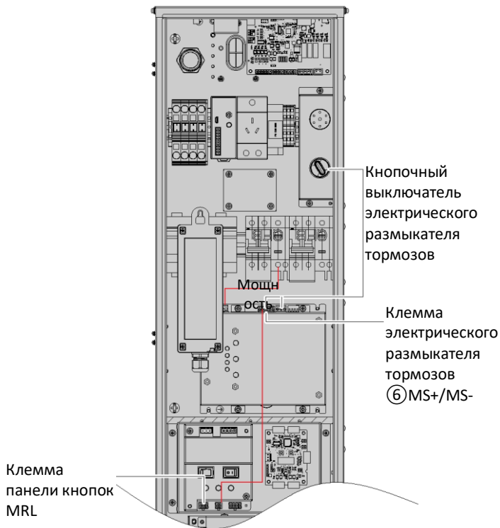
Рисунок 1-30 Подключение электрического размыкателя тормозов шкафа управления пожарного лифта
