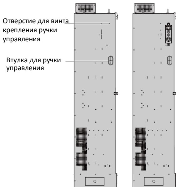
Рисунок 4-26 Установка ручки ЕЕО шкафа управления MR (модели от 45 кВт до 110 кВт)
