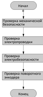
Рисунок 9-2 Блок-схема проверки безопасности и проводки перед подачей питания
