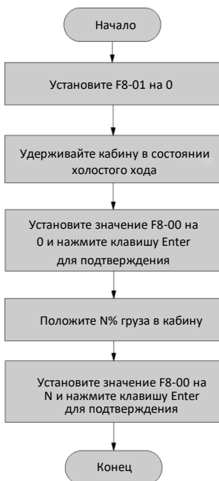
Рисунок 11-3 Блок-схема автоматической настройки аналогового режима полной загрузки/перегрузки
