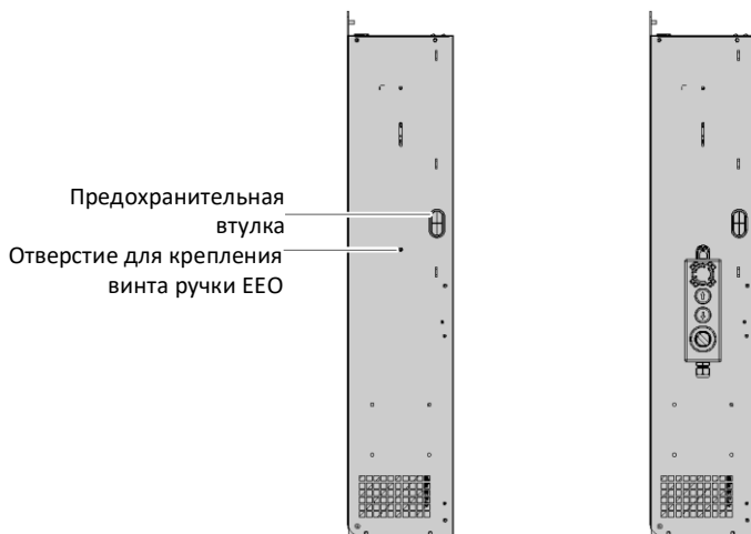
Рисунок 4-25 Установка ручки ЕЕО шкафа управления MR (модели мощностью 37 кВт и ниже)
