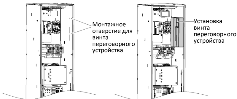
Рисунок 4-22 Установка переговорного устройства для шкафа управления MRL (37 кВт и ниже)
